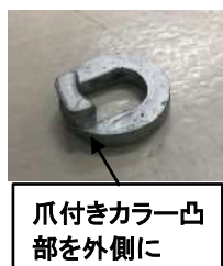
①前輪組立にあたり 前ホーク爪左右側には特殊爪付きカラーを組み込みます
