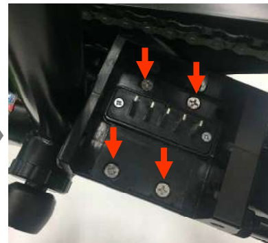
⑤コントローラーボックス上部 フレームに取付のM4+皿ネジ 4点を外します。
