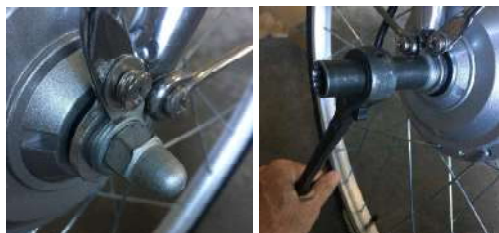
③前輪モーターハブのナット(15mm)を ラチェットレンチ、スパナ、モンキーレンチで緩め前ホークから外す
