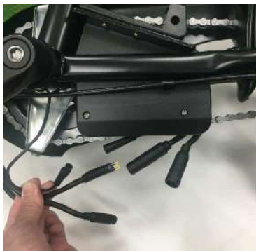
④引き出した3本のコードジョイントコネクタを引き抜き外します。
