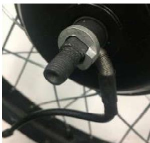
①前輪組立にあたり 前ホーク爪左右側には特殊爪付きカラーを組み込みます
