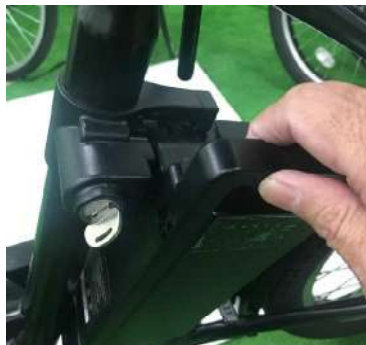
②バッテリーのハンドルを手前に倒し引き抜きます
