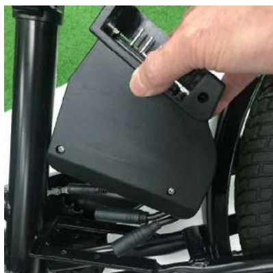
⑥コントローラーボックスをフレームから引き抜きます。
